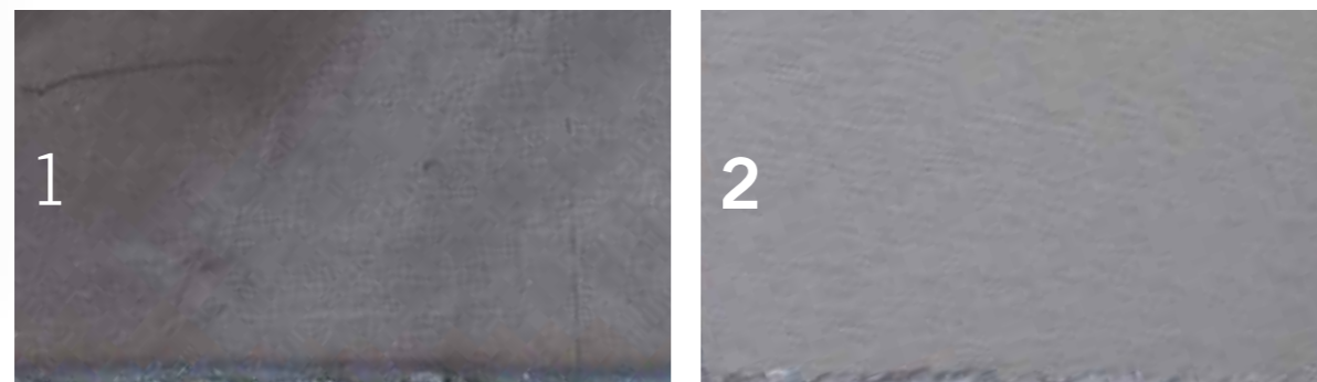
sbavatura su taglio al plasma _ on plasma cutting
