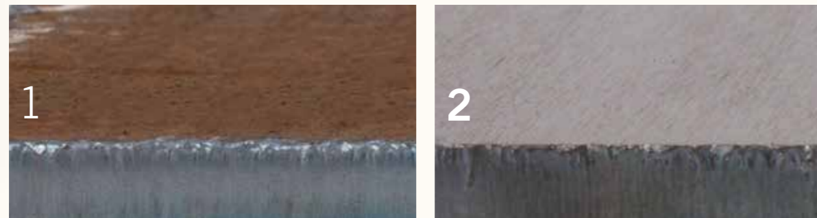
sbavatura su pezzo ossitagliato _ on oxycut workpieces
