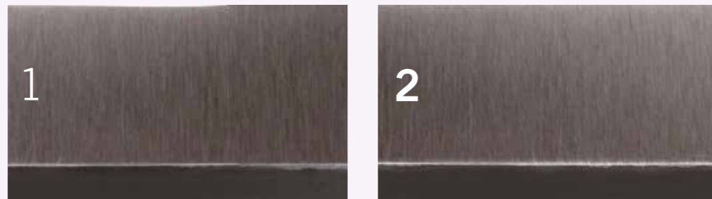
arrotondatura su pezzo ossitagliato _ on oxycut workpieces
